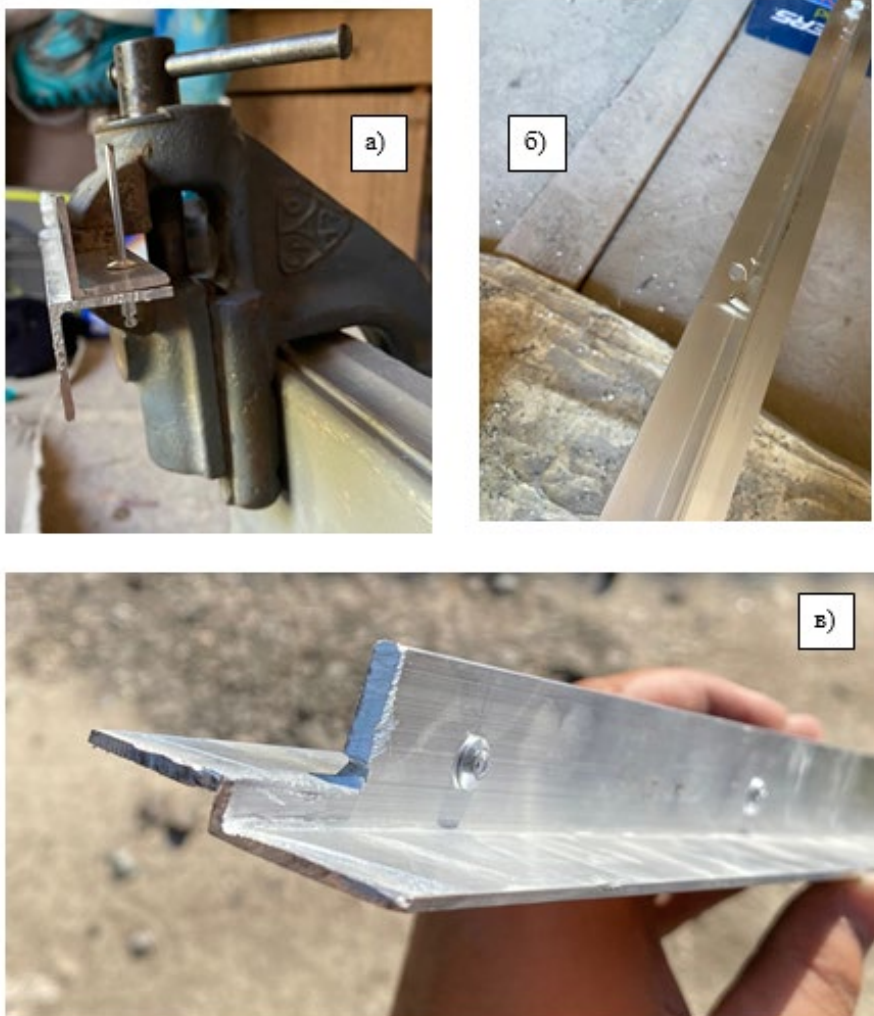
Рис. 3. Изготовление стойки рамы из алюминиевых уголков: а) – фиксация в тисках, сверление отверстий и установка заклепки; б) и в) – собранная на заклепках вертикальная часть рамы
