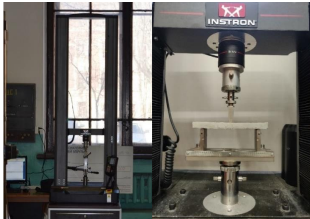
Рис.3. Расположение образца в испытательной установке Instron 5965 Fig.3. Sample Location in the Instron 5965 Test Set
