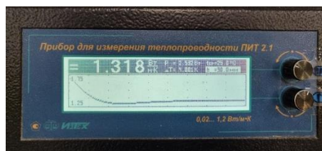
Рис.9. Определение теплопроводности материала на приборе ПИТ-2.1 Fig.9. Determination of the thermal conductivity of the material on the device PIIT-2.1
