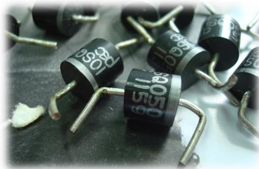
Рис. 6. Полупроводниковые диоды, расположенные в клеммной коробке и используемые в фотоэлектрических модулях для защиты от затенения (общее количество установленных в модуле 6 единиц).
