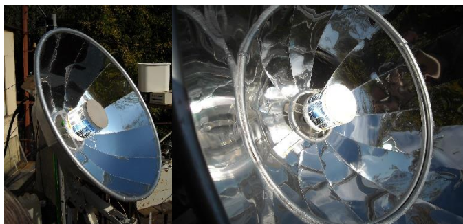
Рис. 5. Теплофотоэлектрический модуль с малым (слева) и с двумя концентраторами (справа) Fig. 5. Photovoltaic thermal module with a small (left) and with two concentrators (right)
