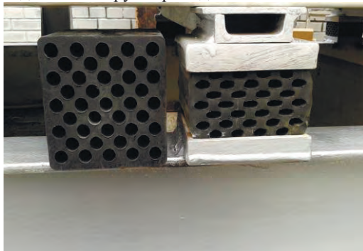
Рис. 1. Виброизоляторы ВИ-1 в свободном состоянии
