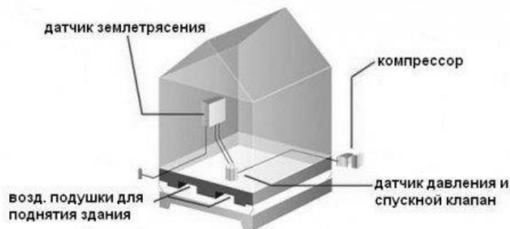
Рис.3 Схема работы сейсмостойких систем
