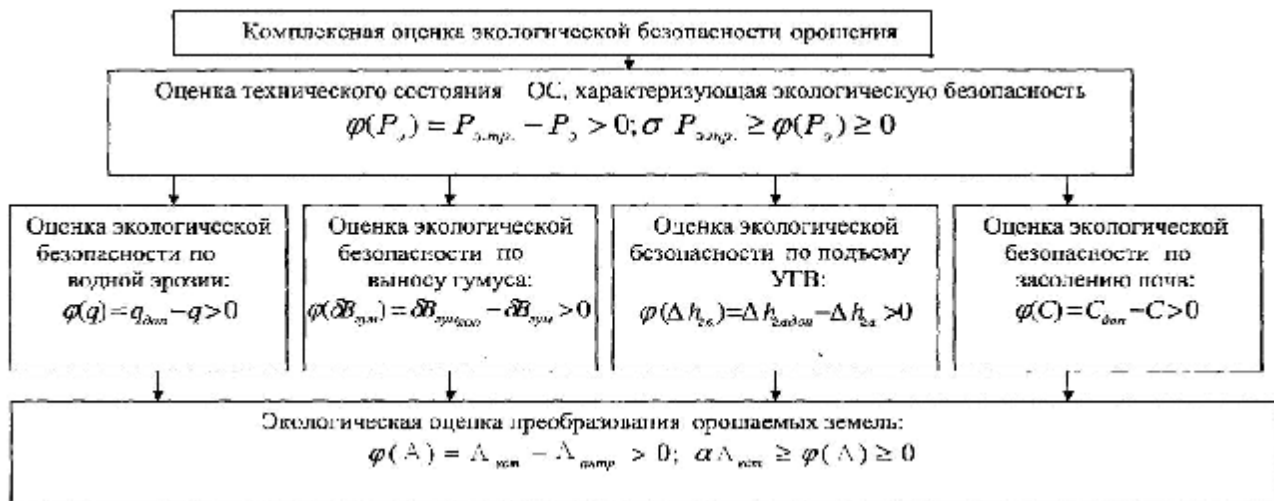
Рис. 1. Комплексная система оценки экологической безопасности орошения: где P_s = \eta / \eta_{\text{тр}} , \eta - фактический КПД оросительной сети; \eta_{\text{тр}} - требуемый КПД оросительной сети; \sigma - коэффициент допустимого снижения КПД оросительной сети; \Delta h_{\text{г.в.дон.}} - допустимое повышение уровня грунтовых вод; \Delta h_{\text{г.в.}} - общее среднее повышение уровня грунтовых вод на орошаемой площади за время t ; C_{\text{дон.}} - допустимая концентрация солей в почвогрунте; C - концентрация солей в точке на глубине h в момент t ; \delta B_{\text{гум.дон.}} - допустимое уменьшение запасов гумуса; \delta B_{\text{гум.}} - изменение вымывания гумуса из почвы; q_{\text{дон.}} - допустимая норма эрозии почв; q - величина водной эрозии почв за счет склонового стока, размыва борозды или полосы и разрушающего действия капель дождя на почву; A_{\text{ест.}} - комплексная оценка (показатель) видового состава естественной территории; A_{\text{антр.}} - показатель видового состава антропогенной территории (при орошении); \alpha - допустимая степень преобразования орошаемых земель.
