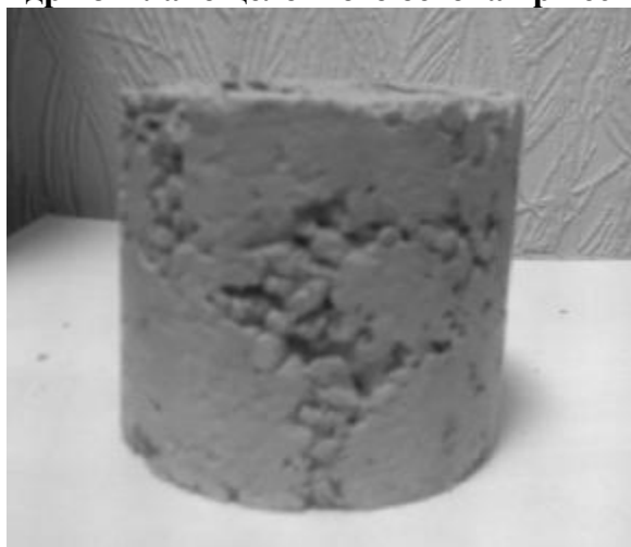
Рис..9 Образец цилиндр из шлакощелочного бетона после ТВО при твердении 28 суток
