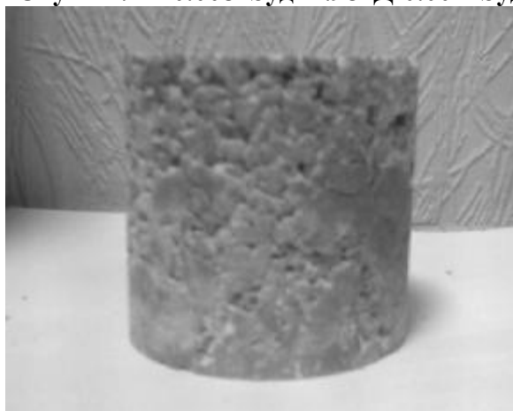
Рис.8 Образец цилиндр из шлакощелочного бетона при естественном твердении
