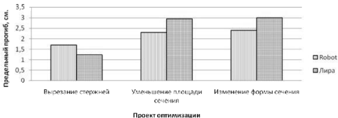
Рис. 5. Сравнение результатов расчёта в Лире и Robot
