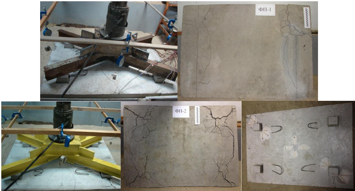
Рисунок 1 - Фото разрушенных моделей плитного фундамента
