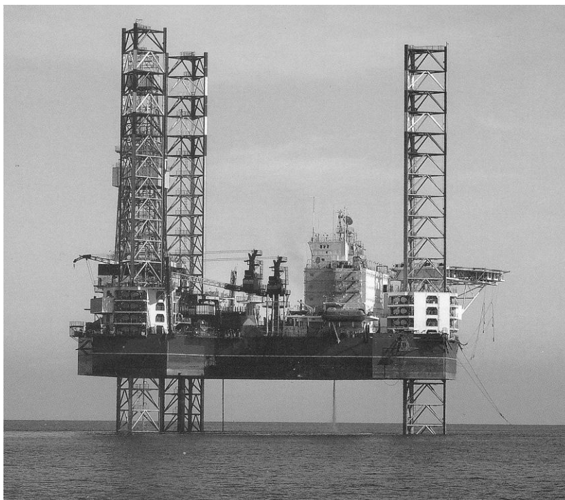
Рис.1 – Общий вид самоподъемной буровой установки (СПБУ)
