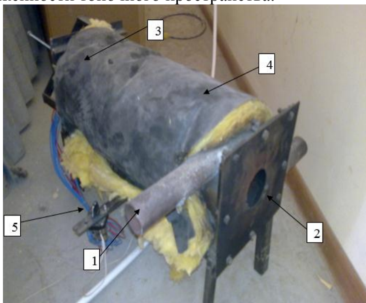
Рис. 1 Экспериментальный стенд с теплоизоляционным кожухом 1 – тангенциальный подвод; 2 – диафрагма; 3 – дроссель; 4 – тепловая изоляция; 5 – хромель-копелевые термопары.
