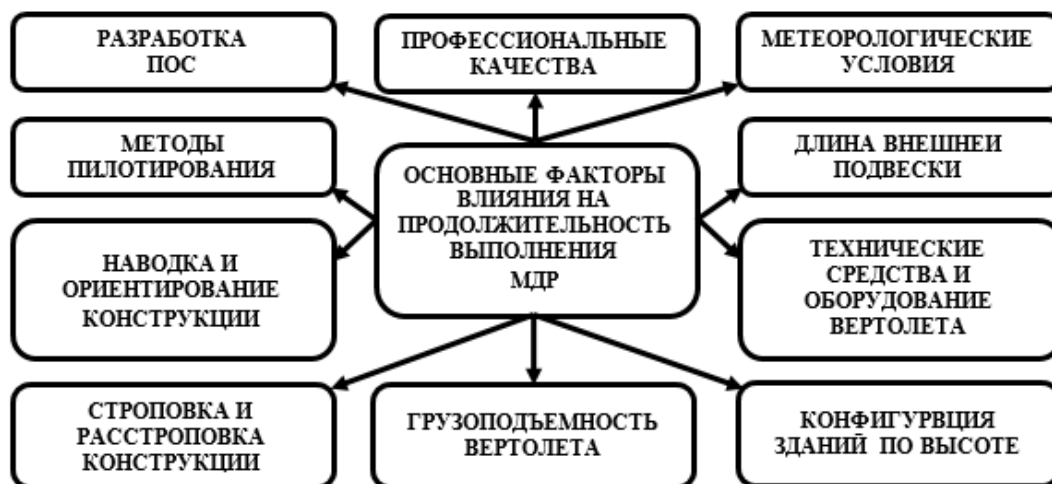
Рисунок 2 – Основные факторы влияния на продолжительность выполнения монтажно-демонтажных работ вертолетом
