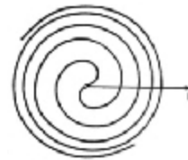
Рис.3. Спиральная траектория движения элементов расширяющегося рабочего тела в фрикционно-вихревой турбины
