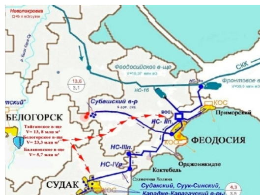
Рис. 3 Схема использование водохранилищ Белогорского района
