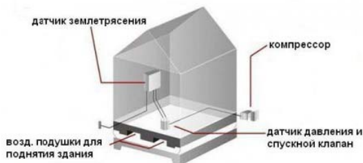
Рис. 2. Схема работы сейсмостойких систем
