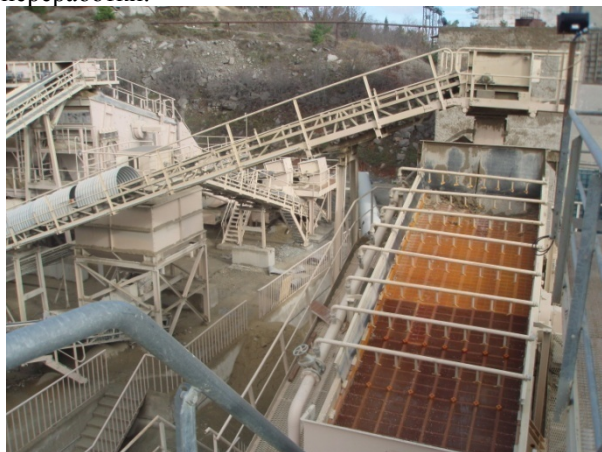
Рис. 1. Промывка породы при производстве щебня и песка
