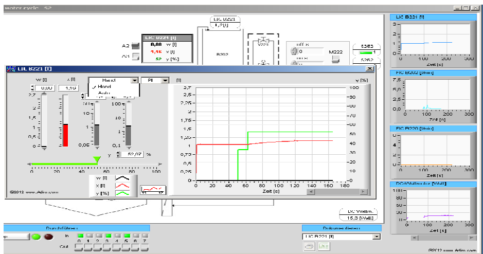
Рис. 3 Снимок экрана FluidLab® «Акватроник Фесто-центр» с ручным управлением насоса
