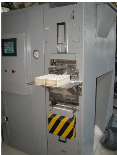
Рис. 4. Оборудование для производства кирпича методом полусухого прессования и вид кирпича
