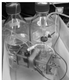
Рис. 9. Макетный образец топливного элемента на основе протонно-обменной мембраны и лабораторно-исследовательской установки ЭХГ
