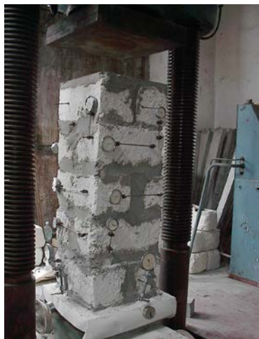
Рис.1. Образец каменной кладки, подготовленный к испытанию
