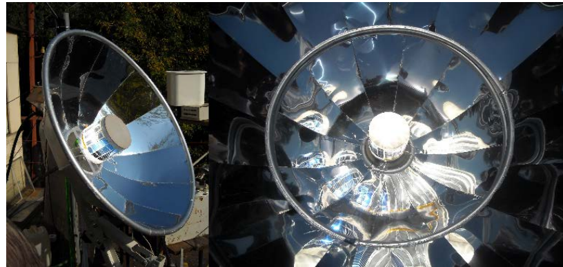
Рис. 12. Концентраторный солнечный теплофотоэлектрический модуль, радиатор которого оптимизировался в системе конечно-элементного анализа Ansys с помощью разработанной методики
