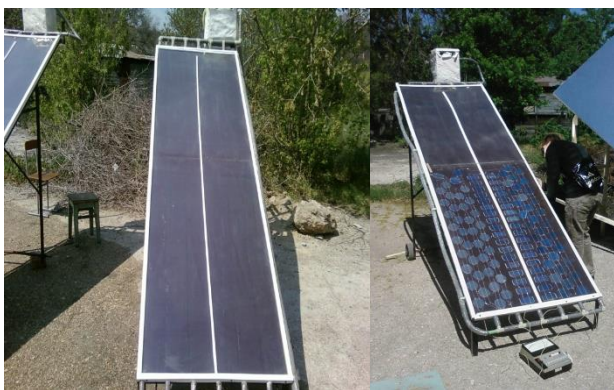
Рис. 2. Тепловая (слева) и теплофотоэлектрическая (справа) солнечные установки
