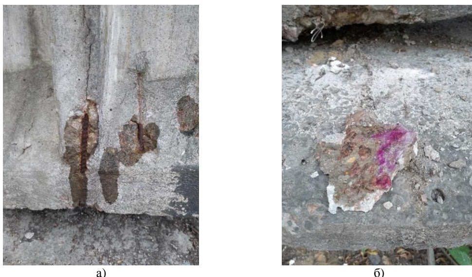
Рис.2. Результаты испытаний методом фенолфталеиновой пробы:
