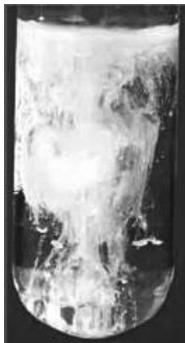
Рис.6. Осаждение сульфат-ионов в растворе ионами бария.
