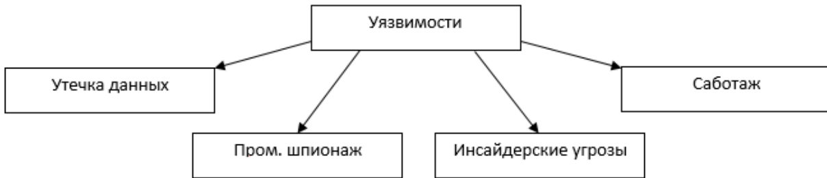
Рис. 1. Основные уязвимости SCADA – систем
