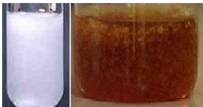
Рис.5. Осаждение хлорид и хромат-ионов в растворе.
