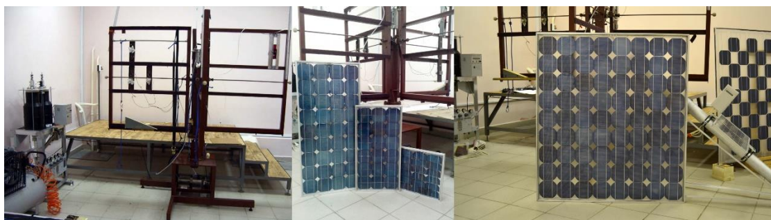
Рис. 4. Установка автоматического смешивания двухкомпонентного полисилоксанового компаунда и солнечные модули, изготовленные с её помощью
