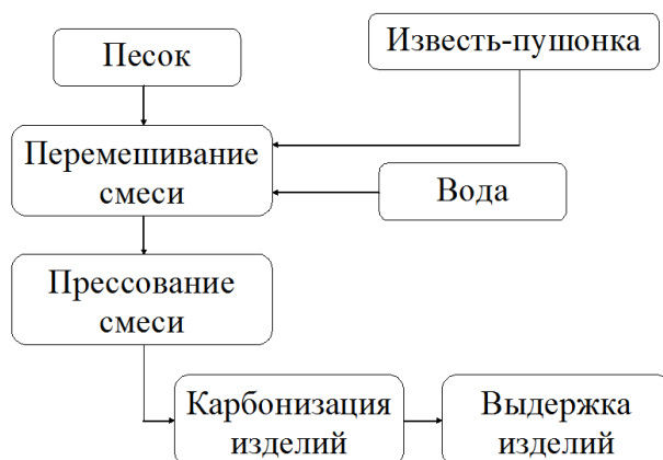
Рис. 2. Технологическая схема производства карбонизированных стеновых материалов из мелкозернистого кварцевого глинистого песка с добавкой извести-пушонки.
