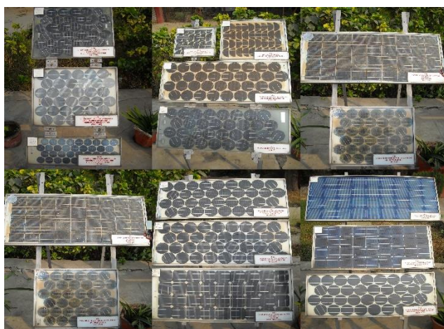
Рис. 3. Солнечные модули, изготовленные с помощью процессов ламинирования с плёнками этиленвинилацетата с 1978 по 1998 г. (India, Sahibabad, Solar Photovoltaic Group. Central Electronics Limited)
