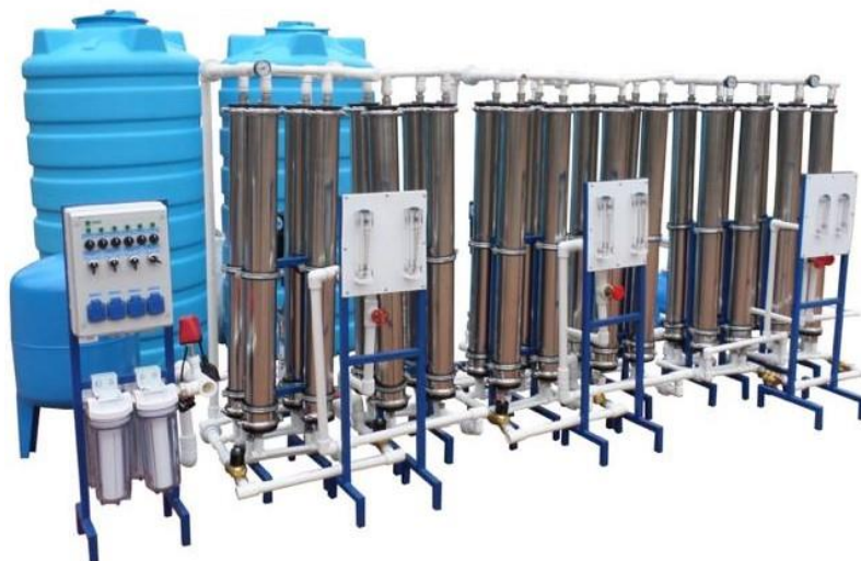
Рис. 7. Пример двухступенчатой установки обратного осмоса для очистки сточных вод и утилизации концентрата производительностью 1000 -1500 литров в час с мембранными аппаратами типа 4040 и баками для реагентного осаждения органических веществ производства компании Waterlab.
