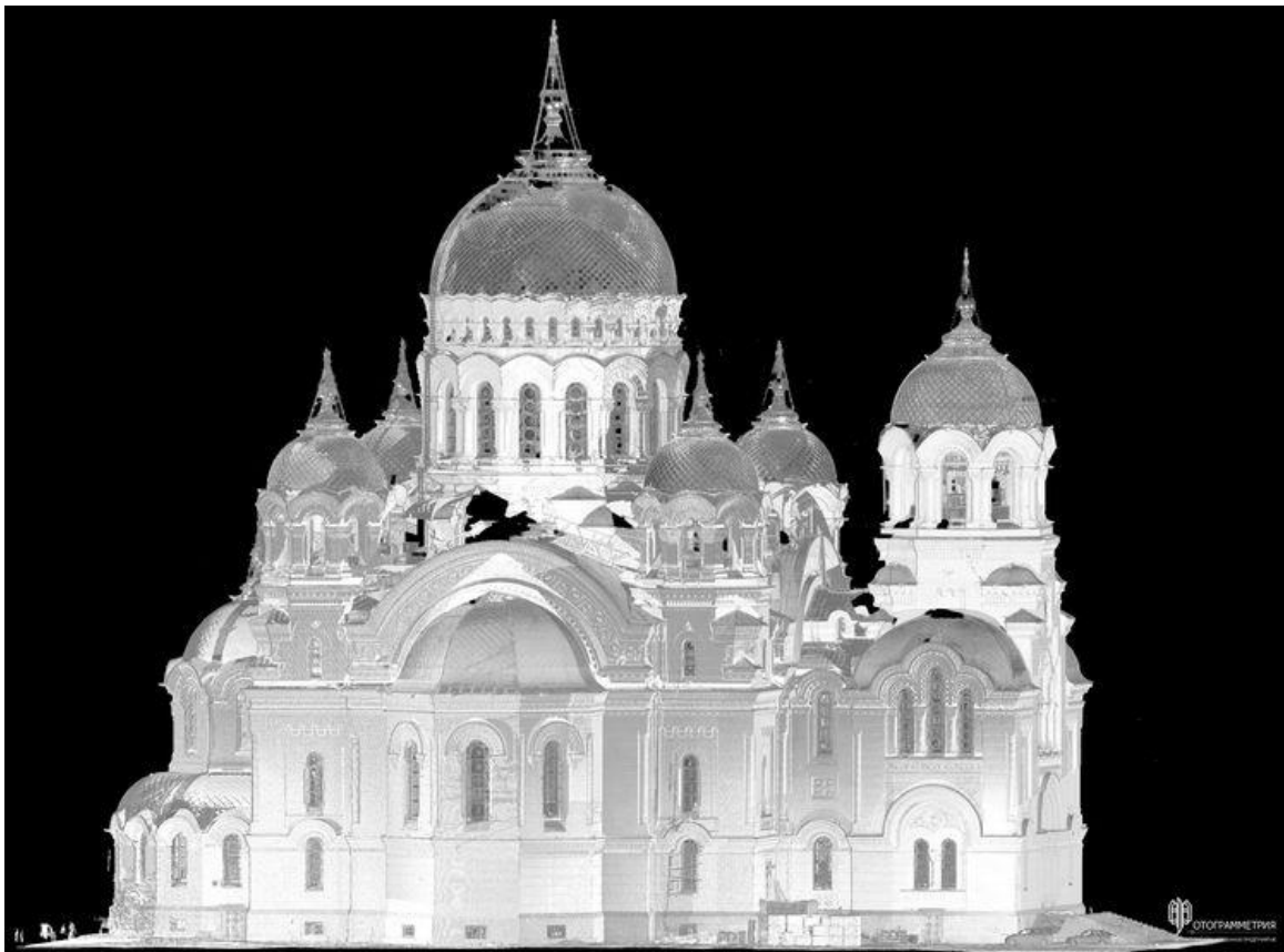
Рис. 5. Результат лазерного сканирования: черно-белая трехмерная точечная модель собора
