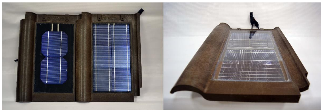
Рис. 5. Планарные (слева) и концентраторная (справа) солнечные черепицы с полисилоксановым компаундом
