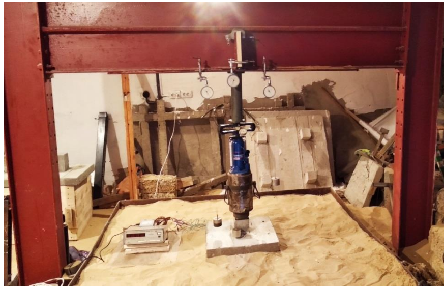
Рисунок 1. Испытание фундаментов в лотке Fig. 1. Testing foundations in a tray
