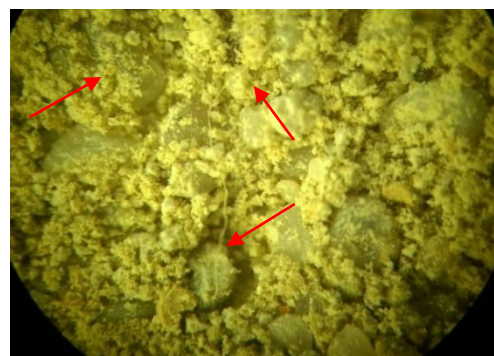
Рис. 4. Фото нерастворимого остатка пробы БМ-25(2) (а) и СШ-1(2) (б). Стрелкой отмечены микроволокна Fig. 4. Photo of the insoluble residue of the sample BM-25(2) (a) and SSh-1(2) (b). Arrow marks microfibers
