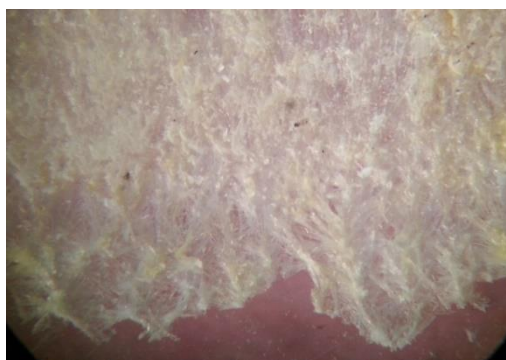
Рис. 5. Фото кристаллов ангидрита в нерастворимом остатке пробы ГП-1(3) Fig. 5. Photo of anhydrite crystals in the insoluble residue of the GP-1(3)
