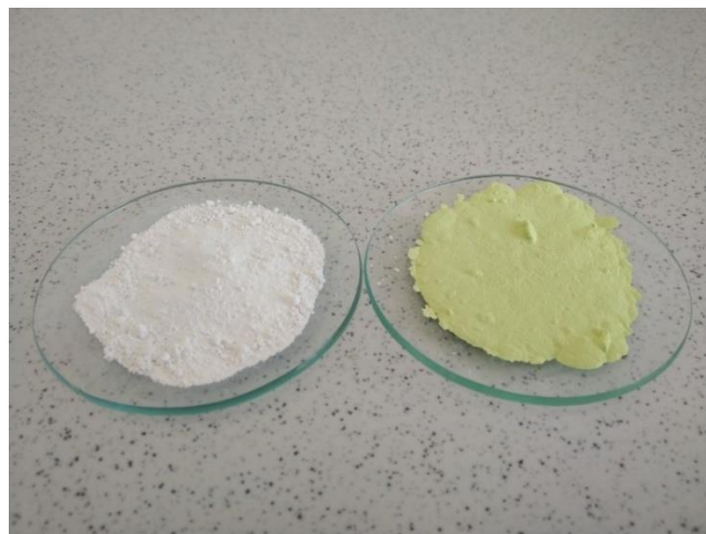
Рис. 4. Общий вид исследуемых порошков: белый – \text{TiO}_2 ; желто-зеленый – \text{WO}_3 . Fig. 4. The general appearance of the powders studied: white – \text{TiO}_2 ; yellow-green – \text{WO}_3 .
