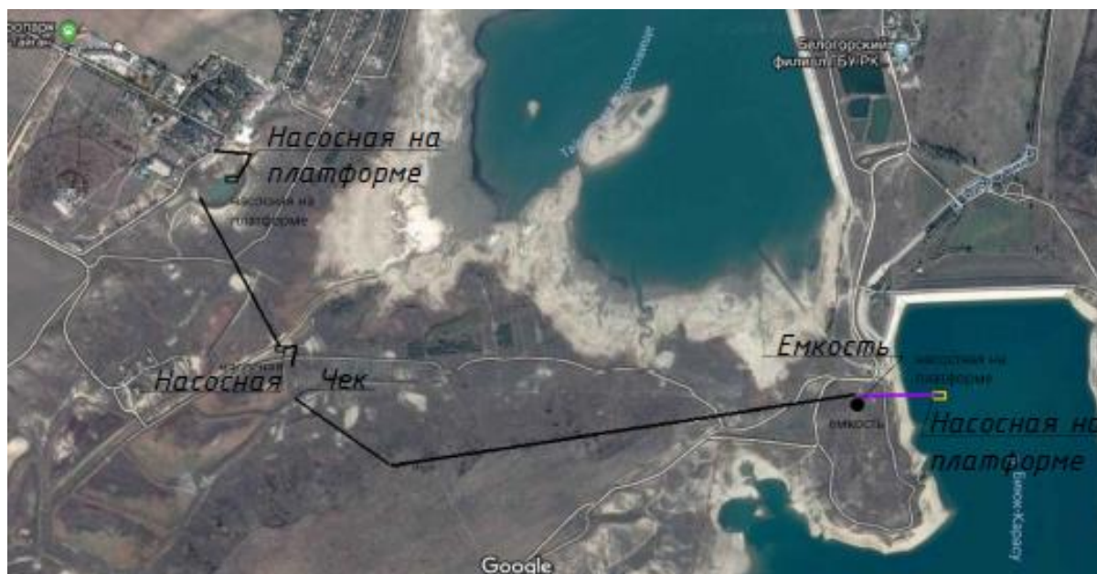
Рис. 1. Схема водоснабжения сафари-парка «Тайган» Fig. 1. Water supply scheme of the Taigan Safari Park
