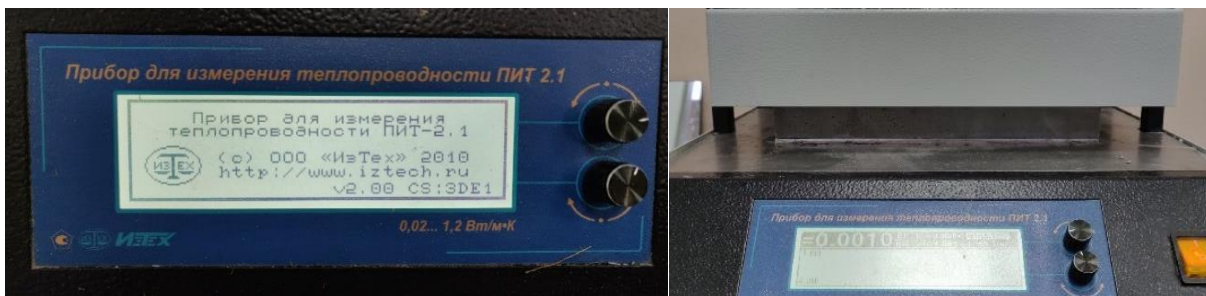
Рис.3. Прибор для измерения коэффициента теплопроводности образца Fig. 3. Device for measuring the thermal conductivity coefficient of a sample
