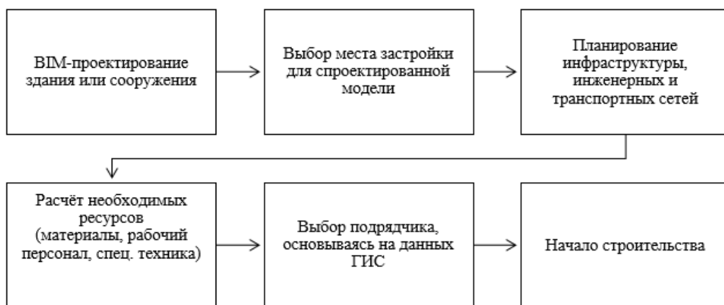
Рис. 5. Схема BIM-проектирования с использованием ГИС Fig. 5. BIM design scheme using GIS
