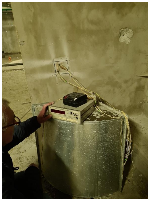
Рис. 4. Измерения остаточных напряжений Fig. 4. Residual stress measurement
