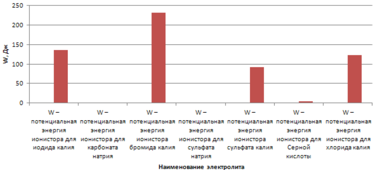
Рис 3. Диаграмма потенциальной энергии заряженного ионистора для разного рода электролитов Fig.3. Diagram of the potential energy of a charged ionistor for various kinds of electrolytes
