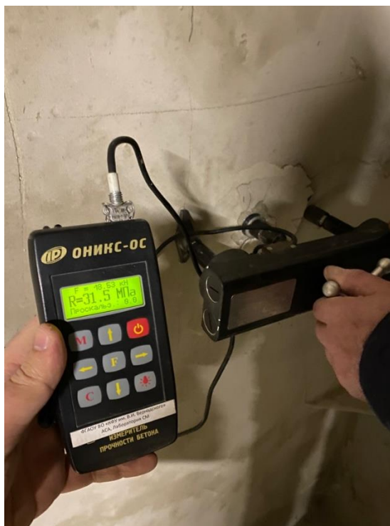
Рис. 2. Определение прочности бетона Fig. 2. Determination of concrete strength
