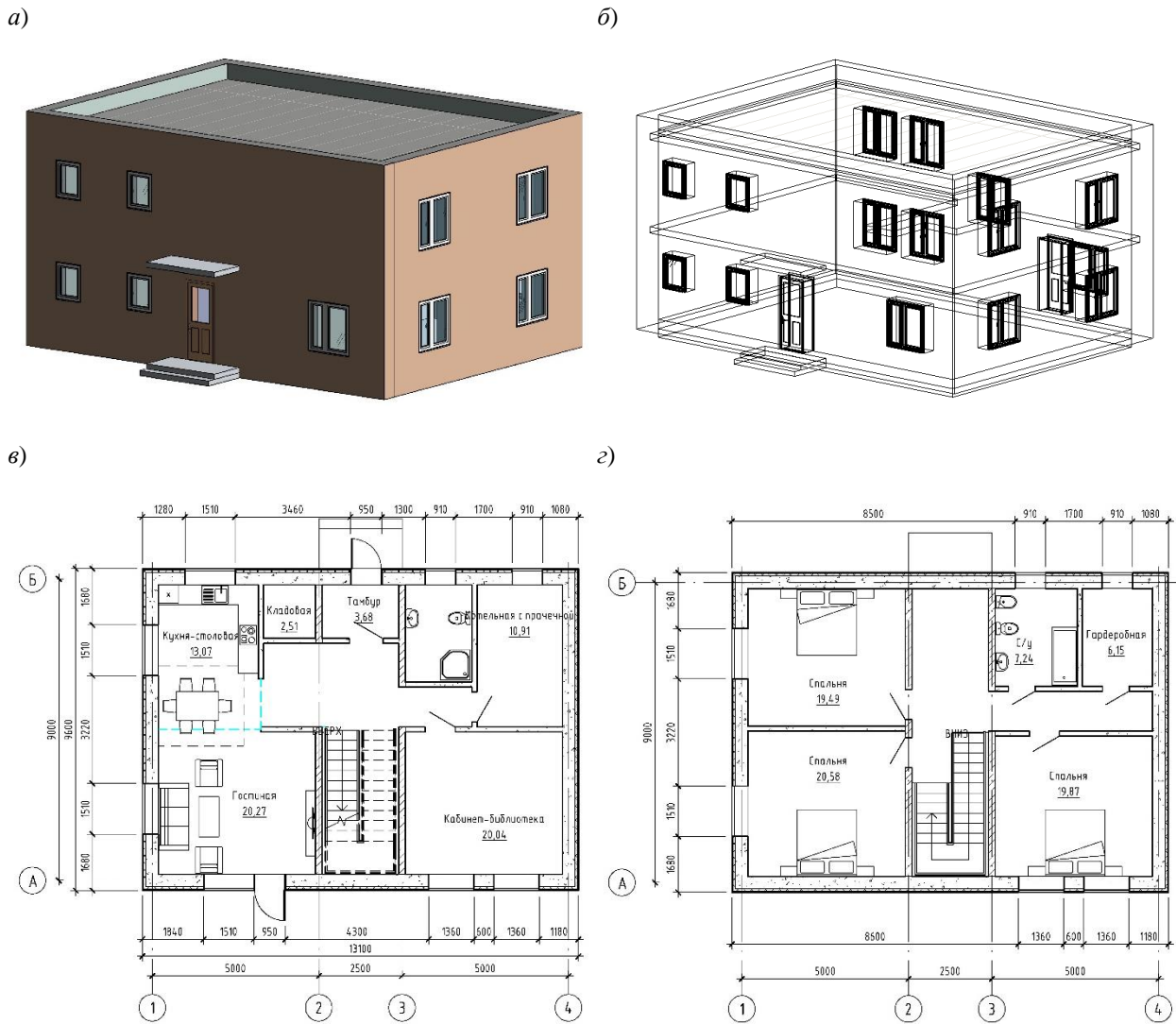
Рис. 1. Описание объекта жилищного строительства, явившегося базой для реализации разработанной методики: а) – изометрическая проекция (общий вид); б) – изометрическая проекция с указанием окон и входных дверей при условно-прозрачных ограждающих конструкциях и отсутствующих внутренних перегородках; в) – план первого этажа; г) – план второго этажа
