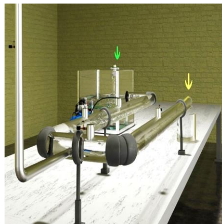
Рис. 1 Схема лабораторного стенда по исследованию водно-воздушного режима работы самотечного трубопровода (слева) и его эскиз в аксонометрии (справа):
