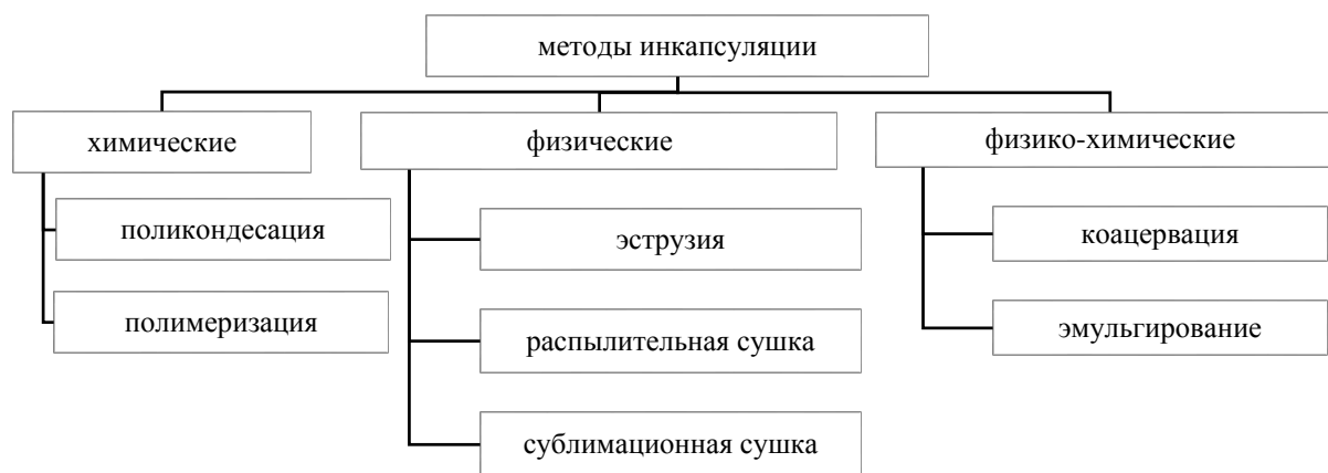
Рис. 1. Методы инкапсулирования бактерий с последующим введением в бетон Fig. 1. Methods for encapsulating bacteria with subsequent introduction into concrete
