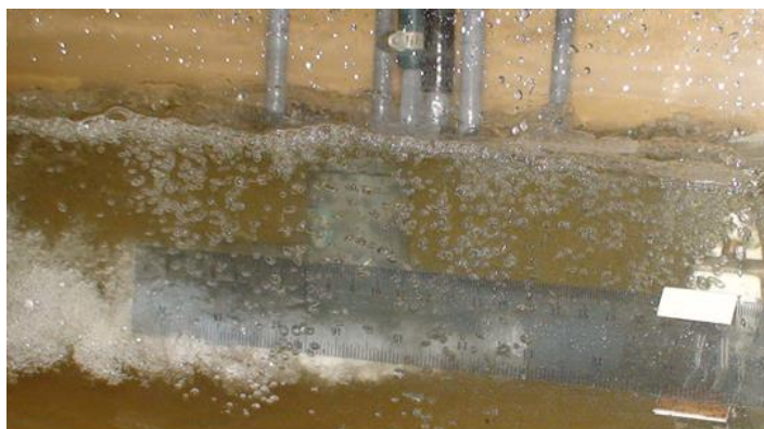
Рис. 10. Выбранная точка измерения в зависимости от длины факела пузырей Fig. 10. Selected measuring point depending on the length of the bubble jet
