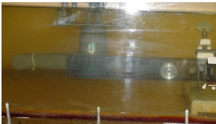
Рис. 8. Пневмогидравлический аэратор вращающийся готов к работе Fig. 8. Pneumohydraulic rotary aerator ready for operation
