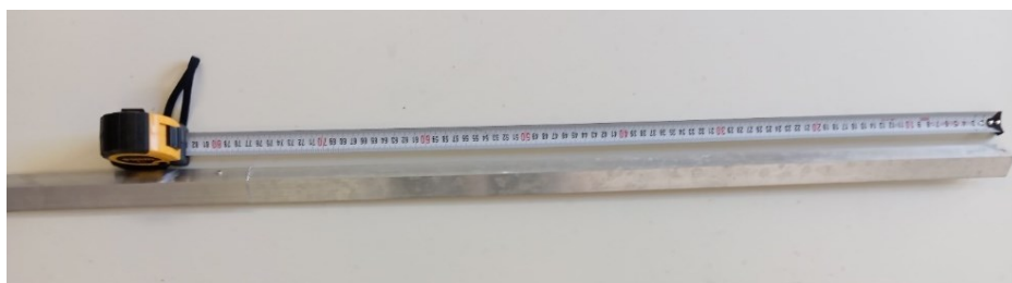
Рис.4. Увеличение длины поперечины технологической оснастки до 2 м на заклепочном соединении уголков из алюминия
