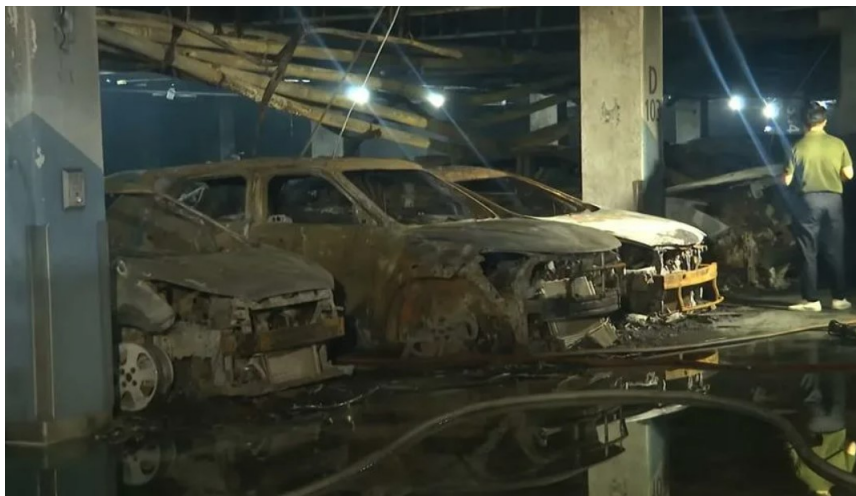
Рис. 1. Закрытый паркинг для электромобилей после пожара (Корея) Fig. 1. Closed parking for electric vehicles after a fire (Korea)
